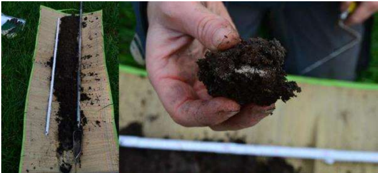
Figuren 45 en 46: Boring 11 en het lensje zand op een diepte van 100cm (foto: auteur)
