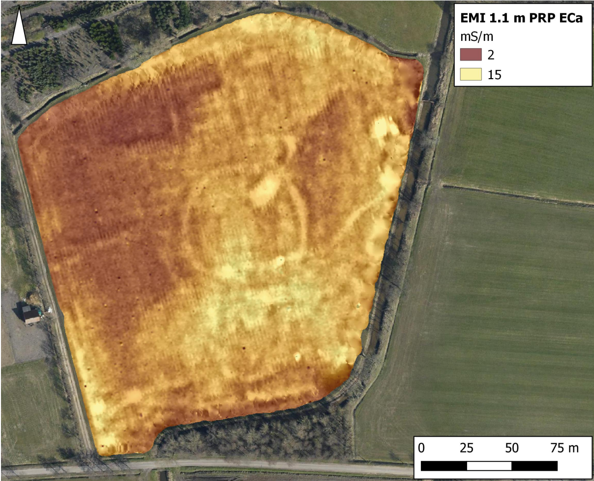
B 3: 1.1 m PRP ECa data. Overlay ongefilterde data boven hipass gefilterde data (zoekvenster 10 m diameter)
